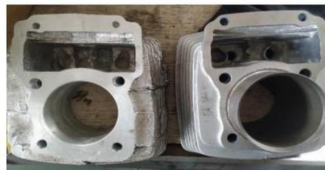
Una vez mecanizado el prototipo de block se procede a insertar la camisa donde se desplazará el pistón dando como se muestra en la siguiente imagen a continuación.
